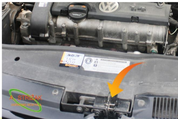
1 pav. Antrinis užraktas variklio skyriaus dangčio atidarymui (vw)
